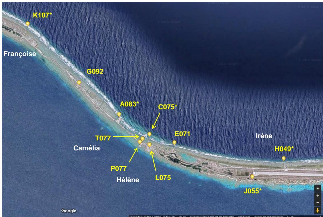
Figure 17 : Localisation des dix stations GPS du système TELSITE actuel (fond de carte extrait de Google Maps). Les cinq stations marquées par un astérisque, J055, H049, C075, A083 et K107 ont respectivement remplacé les stations JEANNE, HOTEL, GPS1, ALPHA et KILO du système de surveillance précédent.
